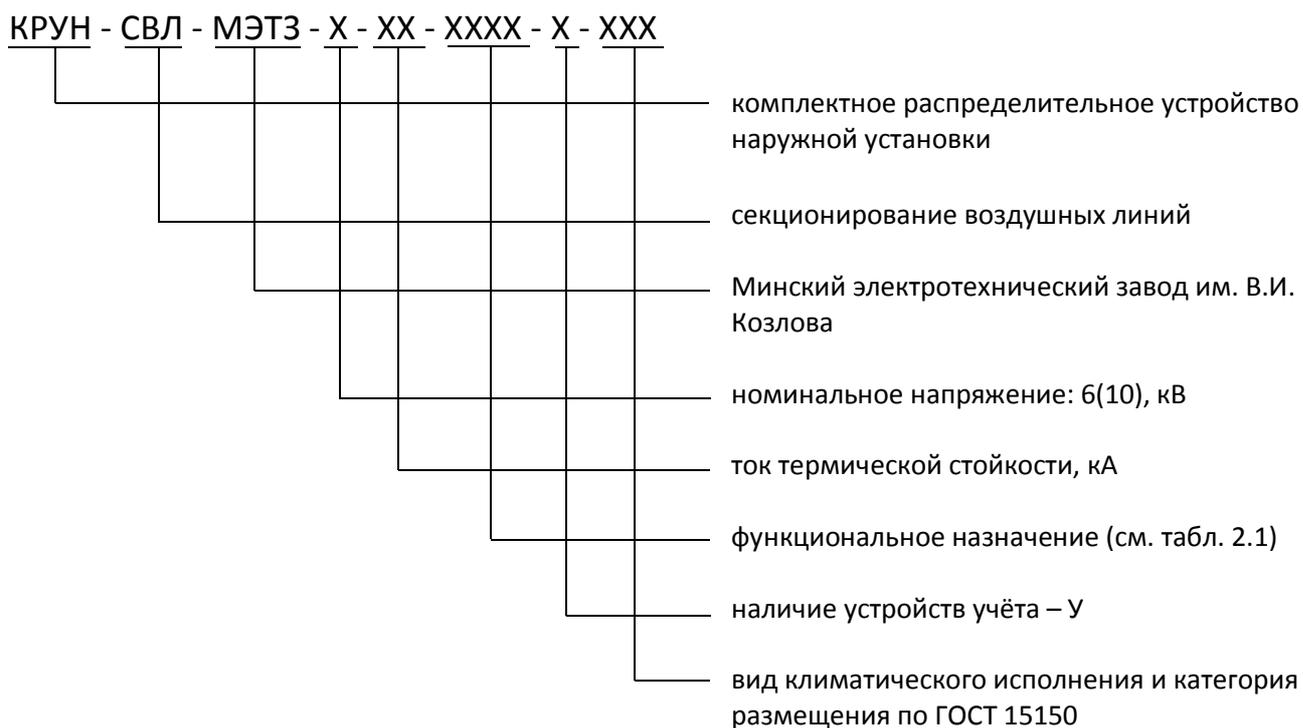
Пример записи обозначения КРУН-СВЛ-МЭТЗ на номинальное напряжение 10 кВ, ток термической стойкости 20кА, предназначенное для секционирования линий с односторонним питанием с АПВ, вид климатического исполнения У1 при заказе оборудования: КРУН-СВЛ-МЭТЗ-10-20-ПАПВ1-У1.
