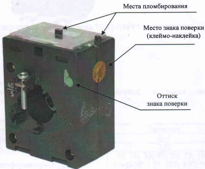
Рисунок 6 - Внешний вид трансформаторов тока ТШП-0,66УЗ на первичные токи от 100 до 500 А
