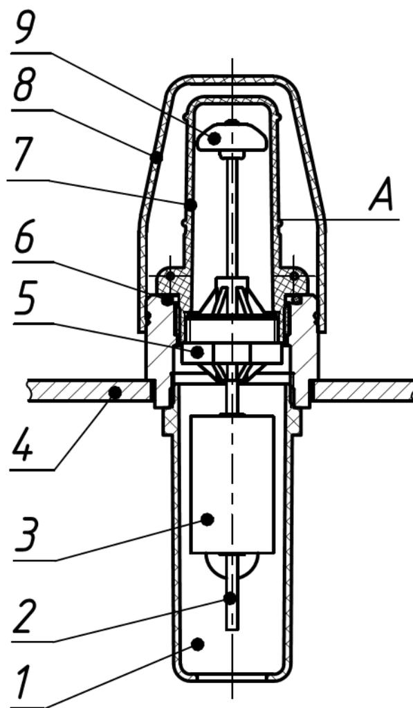
1 – стакан; 2 – шток; 3 – поплавок; 4 – крышка трансформатора;
