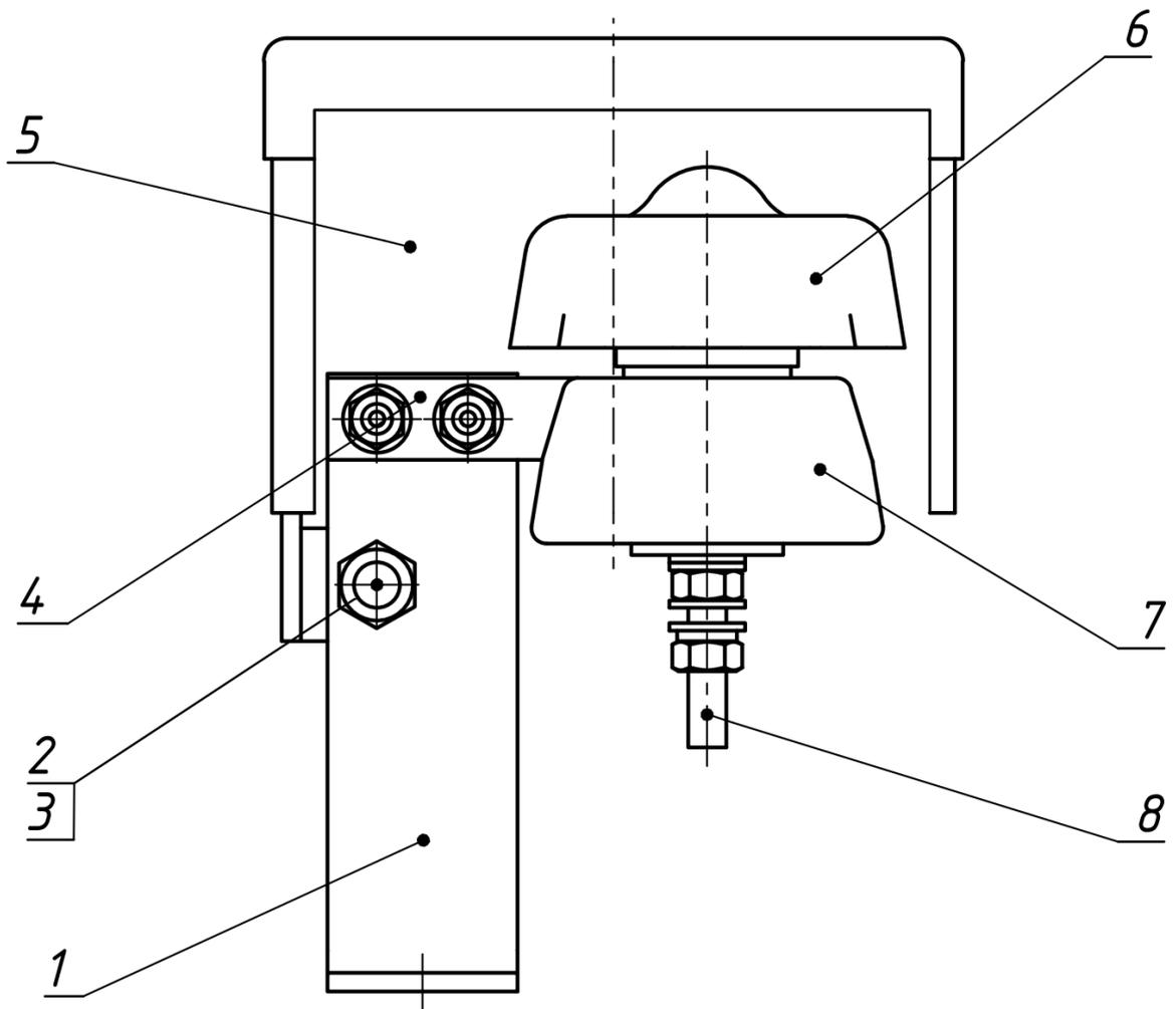
1 – угольник; 2 – винт; 3 – гайка; 4 – контактная скоба; 5 – колпак предохранителя; 6 – фарфоровая головка; 7 – фарфоровое основание; 8 – контакт (центральный).
