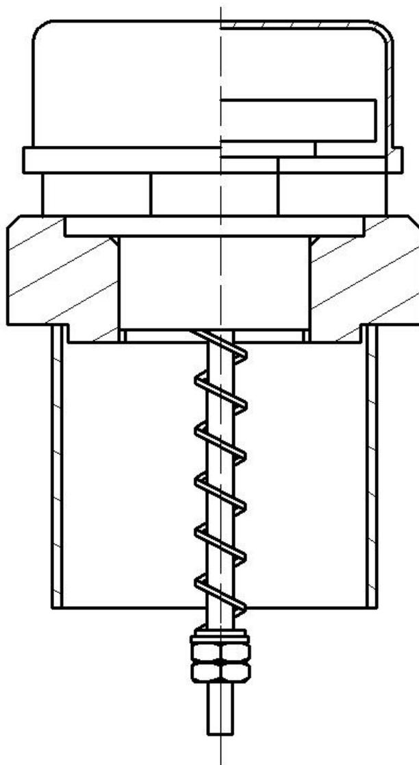
Рисунок А.10 – Предохранительный клапан сброса давления
