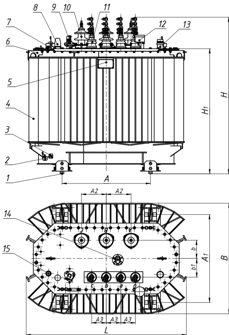
1 – ролик транспортный; 2 – пробка сливная; 3 – зажим заземления;
