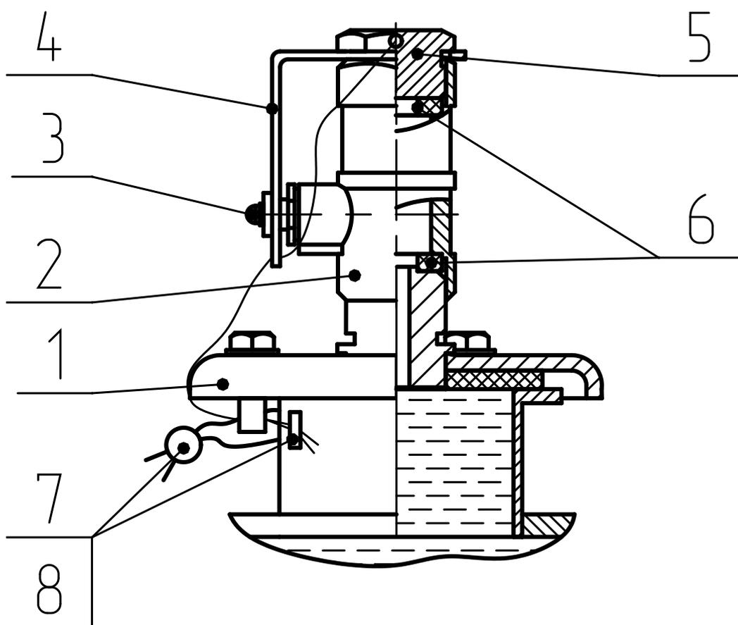
1 - крышка патрубка; 2 - кран шаровой; 3- винт; 4 - ручка крана;
