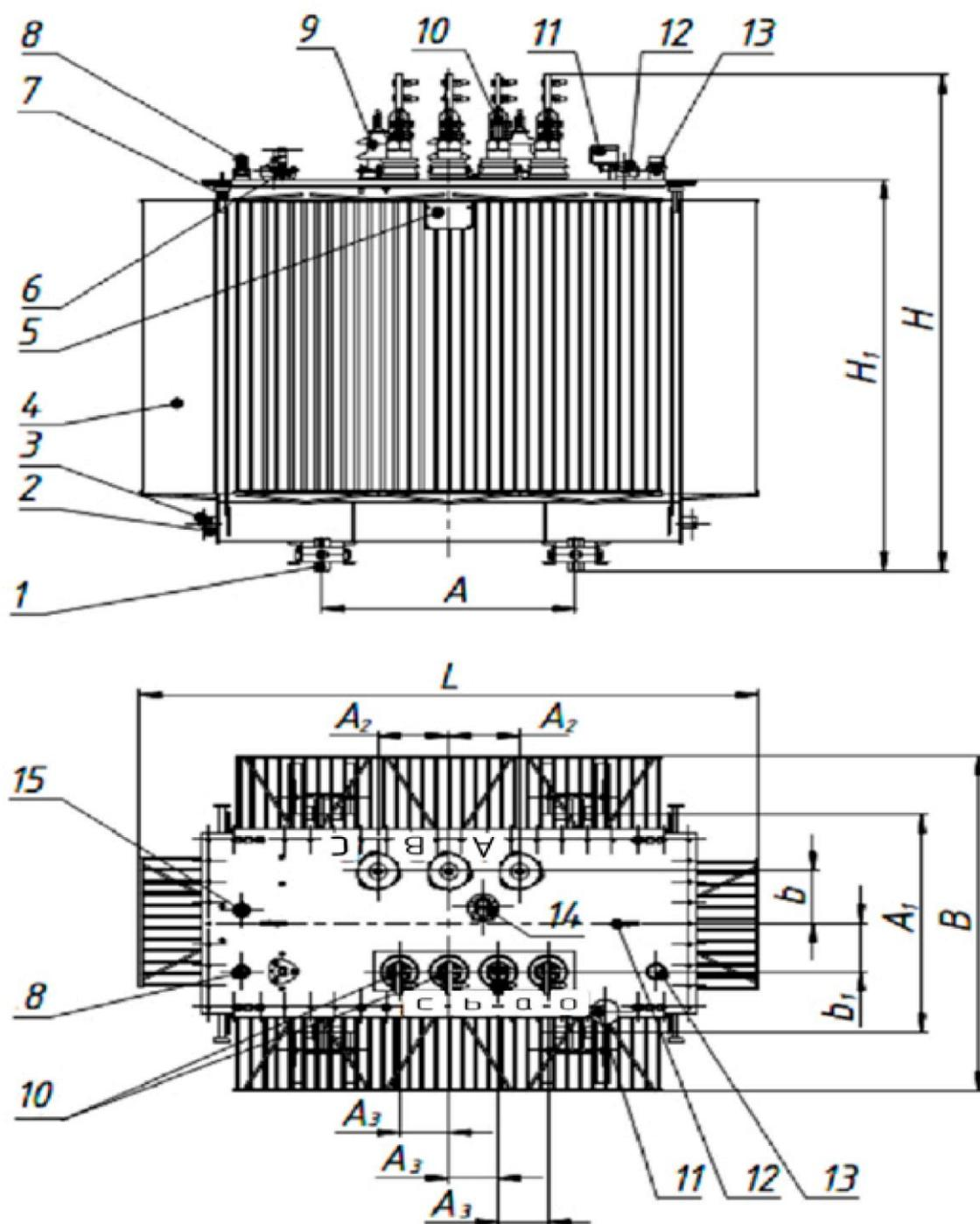
1 – ролик транспортный; 2 – пробка для слива масла; 3 – зажим заземления; 4 – бак; 5 – табличка; 6 – заливочный патрубок; 7 – серьга для подъема трансформатора и крепления трансформатора при транспортировании; 8 – маслоуказатель; 9 – ввод ВН; 10 – ввод НН; 11 – пробивной предохранитель (устанавливается по заказу потребителя); 12 – серьга для подъема крышки трансформатора; 13 – предохранительный клапан сброса давления; 14 – переключатель; 15 – гильза для термометра.
