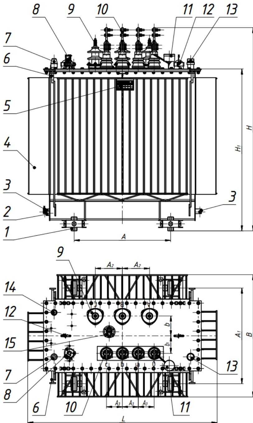
1 - ролик транспортный; 2 - пробка слива масла; 3 - зажим заземления;
