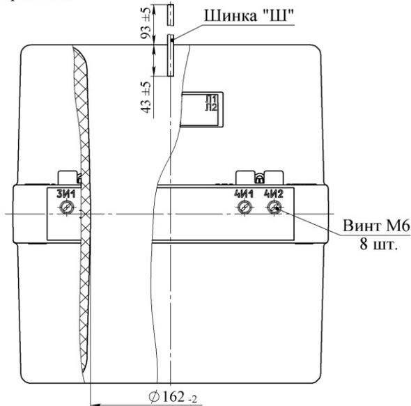
Рис.В.4. Общий вид трансформатора ТЛШ-10-7.1-4 (5,6)
