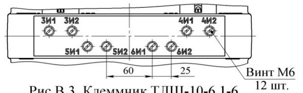
Рис.В.3. Клеммник ТЛШ-10-6.1-6
