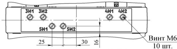
Рис.В.2. Клеммник ТЛШ-10-6.1-5
