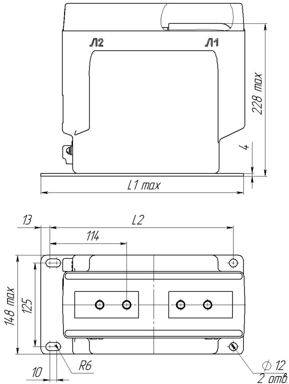
Рисунок Б.8 Общий вид трансформаторов с плитой
