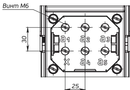
Рис.2 - Панель контактов трансформаторов ОЛ-СВЭЛ-0,63/6(10)М
